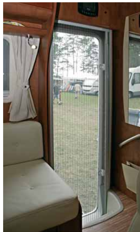
W drzwiach i oknach zamontowane są moskitiery.
